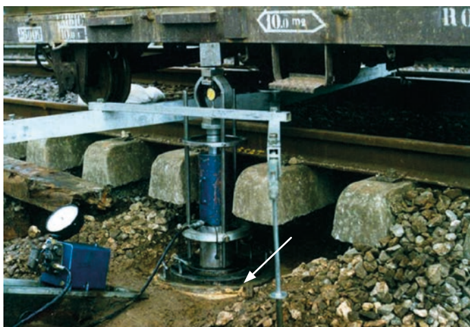
Rys. 2. Badanie płytą uciskową ugięcia podtorza kolejowego z warstwą wyrównującą
