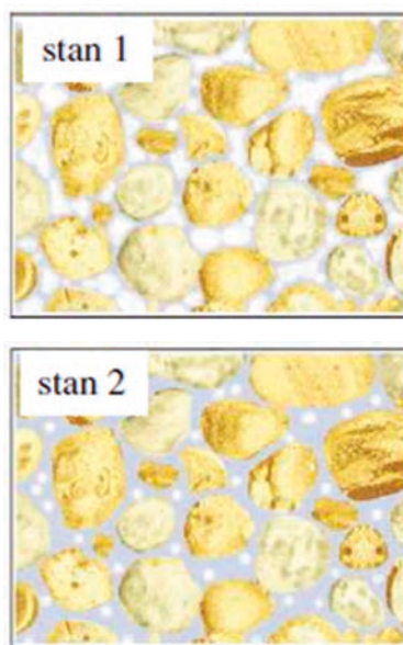
Rys. 1. Wynik badań zagęszczalności w aparacie Proctora ze zróżnicowanym stopniem wilgotności w stanie 1 i w stanie 2 dla jednokrotnie zagęszczonego gruntu
