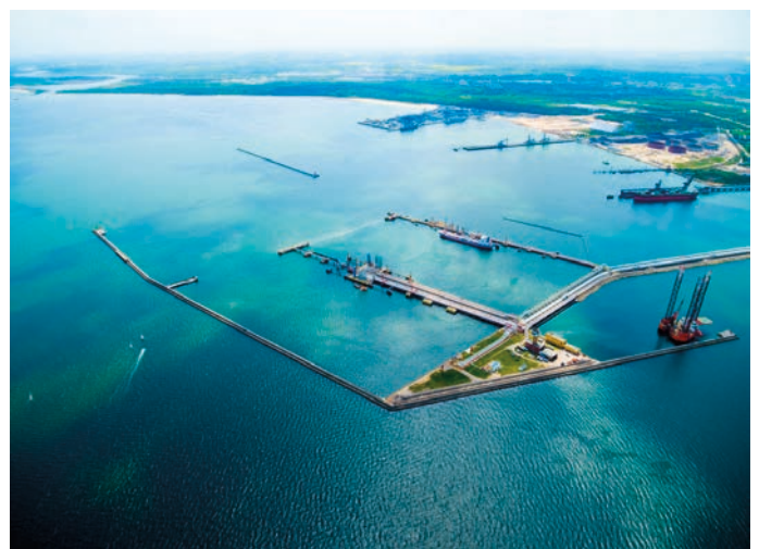
Rys. 4. Port Północny w Gdańsku w widoku; na pierwszym planie terminal paliwowy z dwoma basenami i stanowiskami przeładunkowymi paliw w kolejności „P”, „R” i „T”. W wejściu do Basenu nr 2 widoczna biała przegroda w postaci wału wodnego wytworzonego przez kurtynę powietrzną. W głębi, poza terminalem paliwowym, widoczne kolejno Pirs Węglowy, Pirs Przeładunkowy Gazu LPG, Pirs Rudowy i Terminal Kontenerowy DCT
