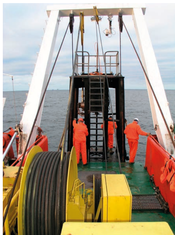
Rys. 7. Bramownica do wystawiania ramy za rufę statku
