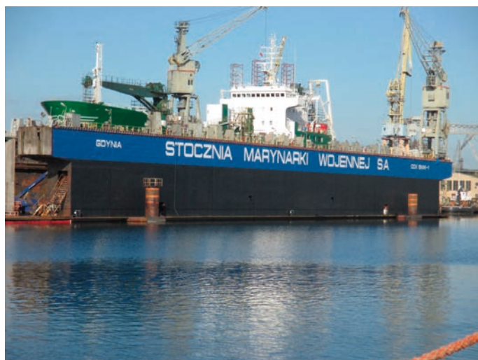
Rys. 5. Dok pływający o nośności 8 000 t wraz z remontowanym statkiem (widoczne obie dalby utrzymujące dok)
