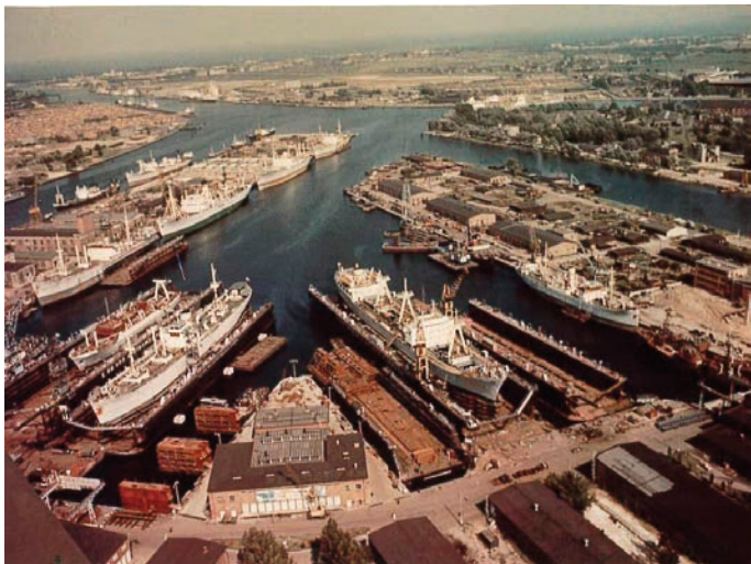
Rys. 1. Perspektywa z widokiem na Gdańską Stocznia Remontową; na pierwszym planie po prawej stronie obok siebie dwa doki pływające – ze statkiem największy dok o nośności 33 000 t
