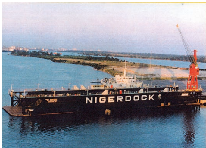
Rys. 7. Widok doku pływającego o nośności 3 000 t w położeniu transportowym w Stoczni Nigerdock II w Nigerii
