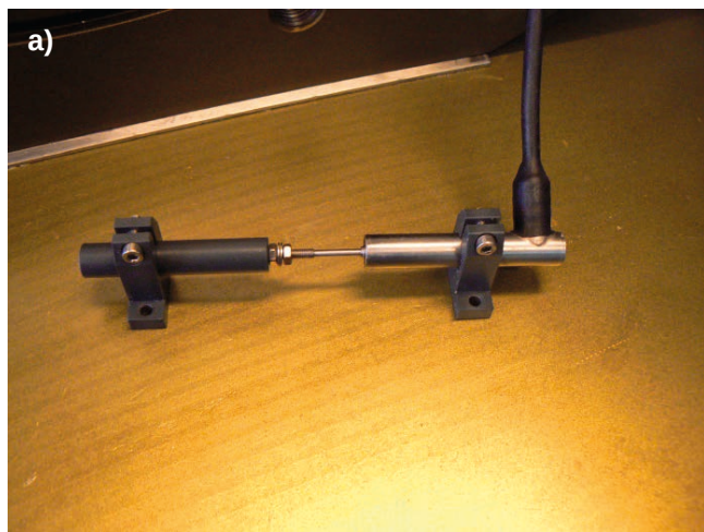
Rys. 3. Napróbkowe czujniki przemieszczeń typu LVDT (a) i Halla (b)
