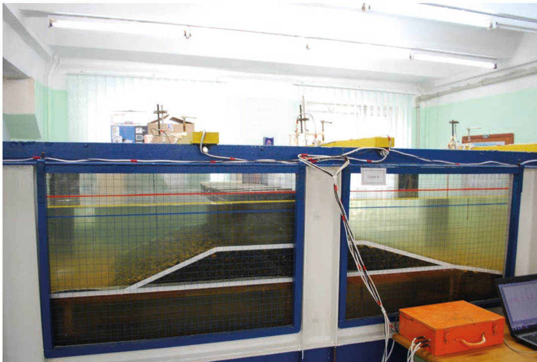
Rys. 3. Widok kanału falowego z modelem falochronu o niepełnym profilu pionowym
