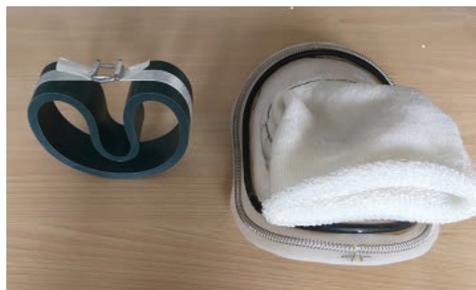
Rys. 3. U-liner DN 150 mm i profil kapeluszkowy z kołnierzem wyposażonym w uszczelkę i spiralę umożliwiającą zgrzanie z linerem w kanale głównym (źródło: Raganowicz)
