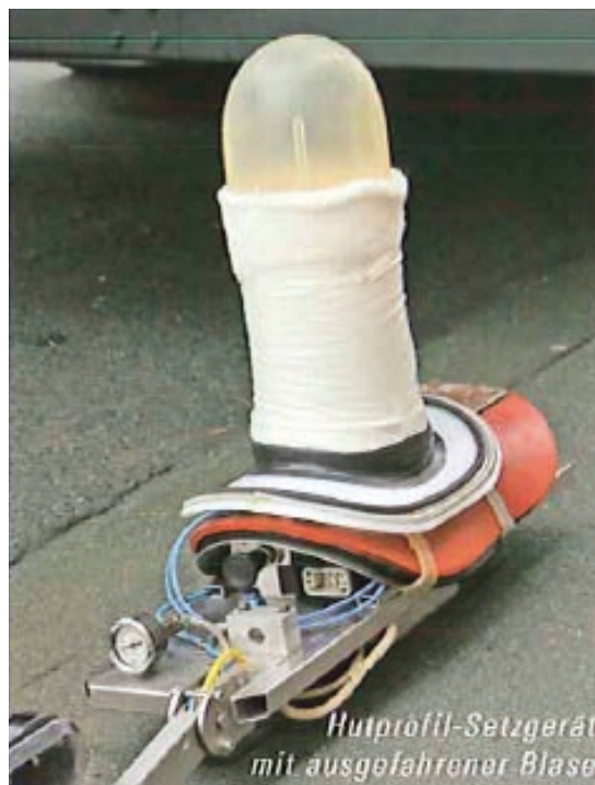
Rys. 7. Robot kanałowy służący do instalacji profilu kapeluszowego typu CP-ZA 1012 [3]
