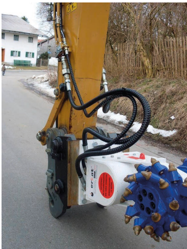
Rys. 1. Głowica frezująca umożliwiająca wykonanie wykopu w miejscach występowania zeskalonych warstw podłoża gruntowego (źródło: Raganowicz)
